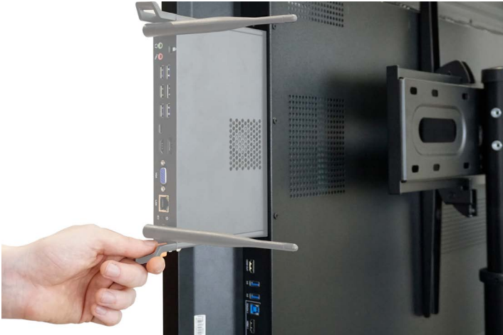
Mini PC side insertion modules The proprietary Mini PC transforms the display in a PC.
